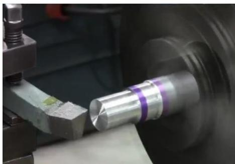
図-1 旋削加工
