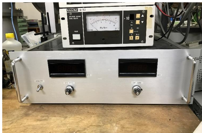
図 3-4 直流高圧電源
