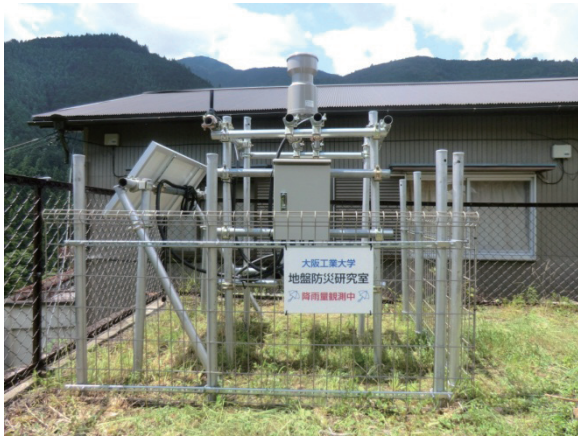
写真一 大阪工業大学（地盤防災研究室）が独自に設置した雨量計（十津川村出谷）
