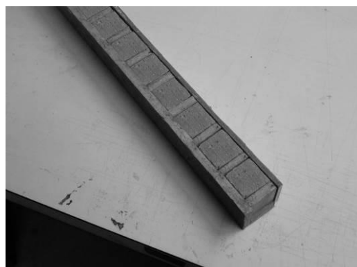
写真6 平衡含水率試験体成型状況
