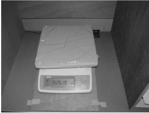
写真 20 熱伝導率測定試験体
