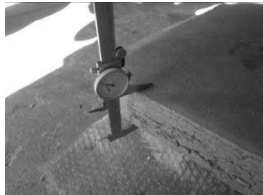
写真12 試験体(900角)の材料厚さ測定状況
