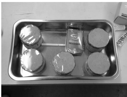
写真 10 限界含水率測定試験体
