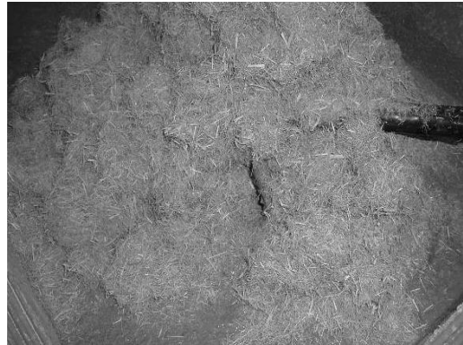
写真2 すさの調合状況
