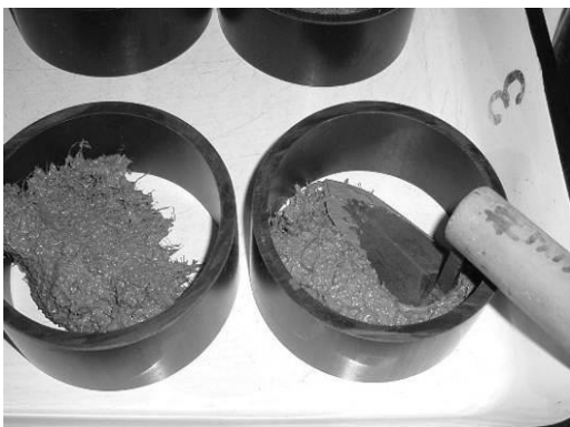
写真5 湿気伝導率試験体成型状況(1)
