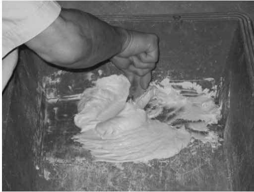
写真 22 試験体の調合状況
