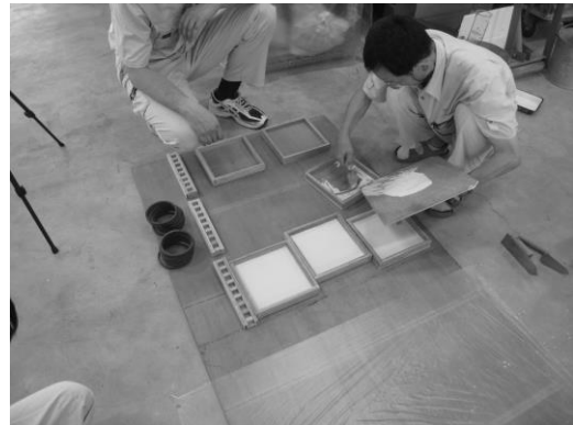
写真 25 熱伝導率試験体の施工状況(2)
