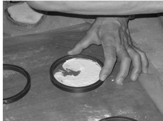
写真 23 熱伝導率試験体の施工状況
