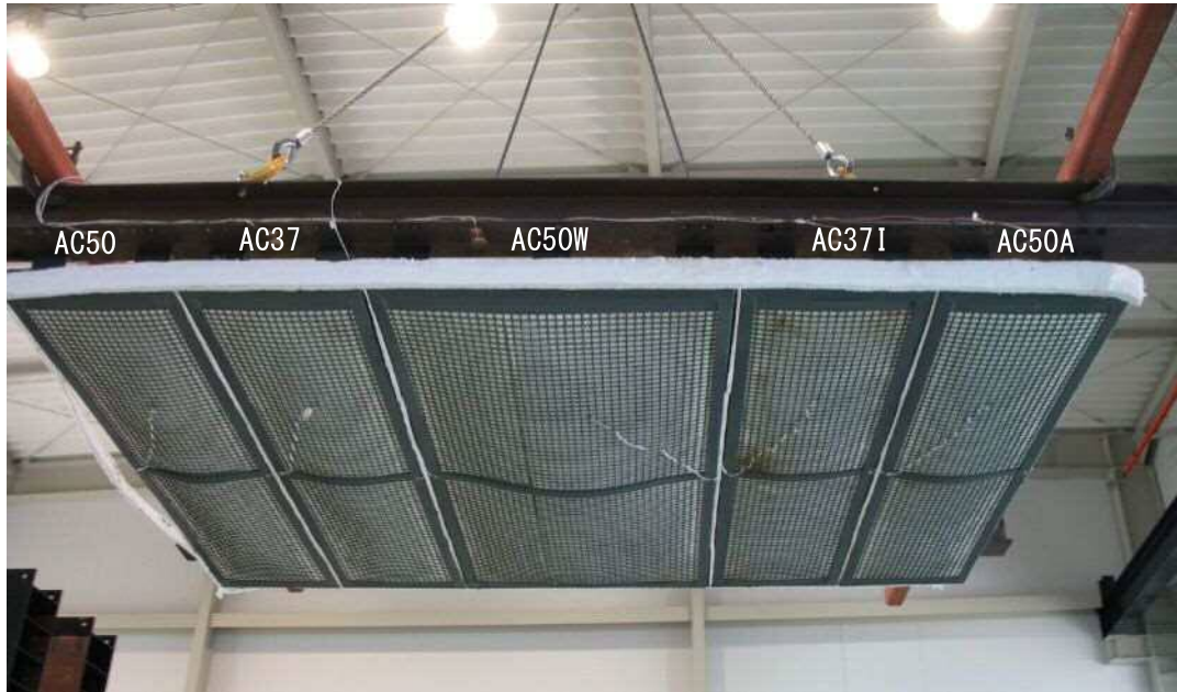
写真-7.5.5 加熱冷却後のフレームの状況
