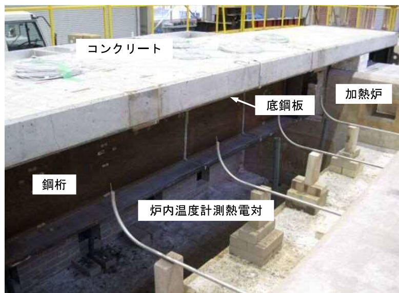
写真-4.2.1 実験供試体の設置状況
