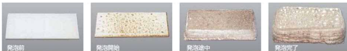
写真-7.3.4 塗装タイプ（加熱発泡型） 7.21)
