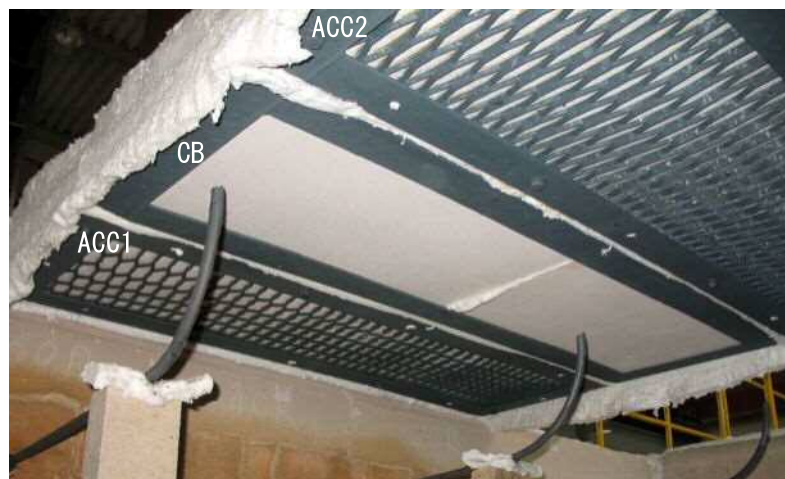
写真-7.5.3 加熱冷却後のフレームの状況
