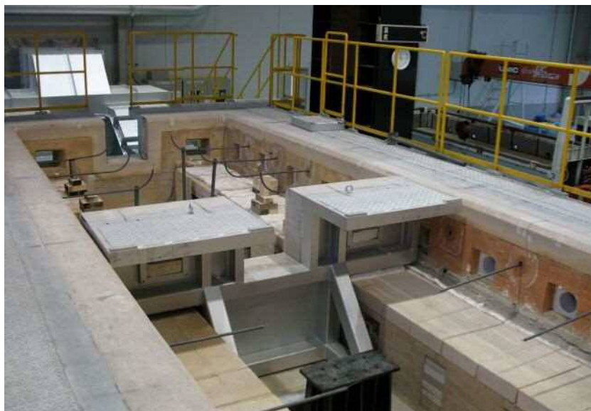
写真-7.5.1 大型水平加熱炉（内部）
