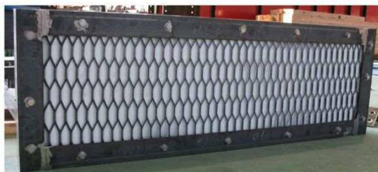
図-7.5.1 実験供試体の形状と測定位置（タイプ-ACC [重量: 約 89kg/m 2 ]
