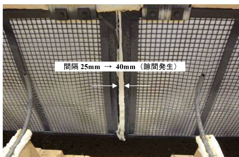
写真-7.5.10 側面用耐火パネルのフレーム（b 部）
