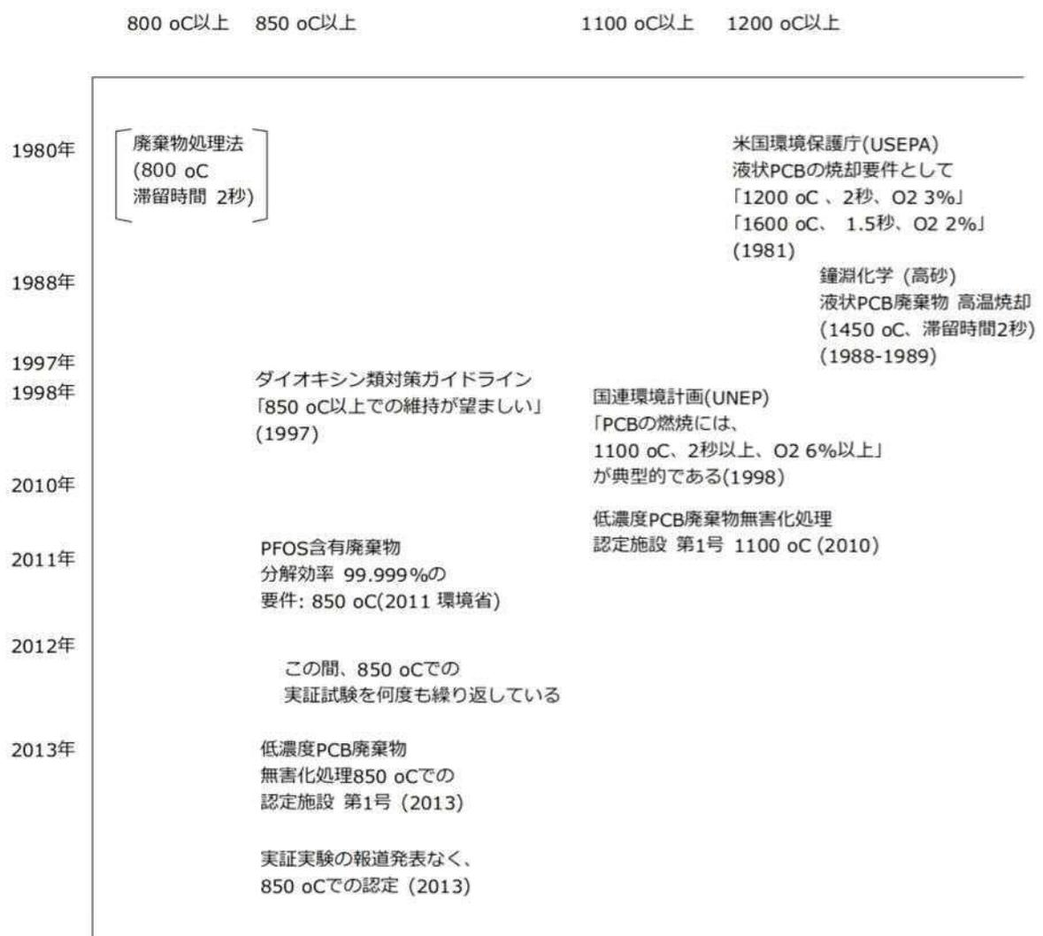
図 5-1 有機ハロゲン化合物の熱化学的処理の条件の変遷
