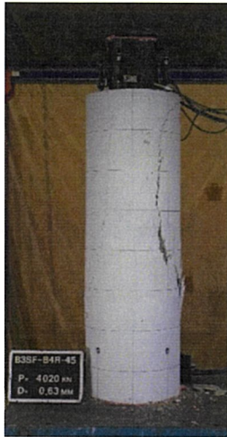
写真 3-4-5 最終破壊状況(B3SF-B4R-45)
