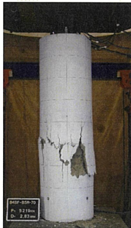
写真 3-4-1 最終破壊状況(B4SF-B5R-70)
