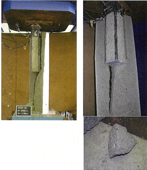
写真 3-3-1 最終破壊状況(B4SF-B5:無筋)
