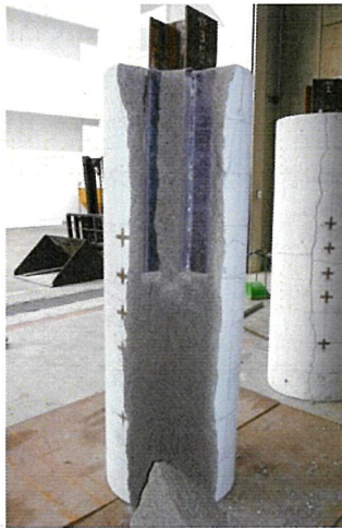
写真 2-2-1 最終破壊状況(支圧)
