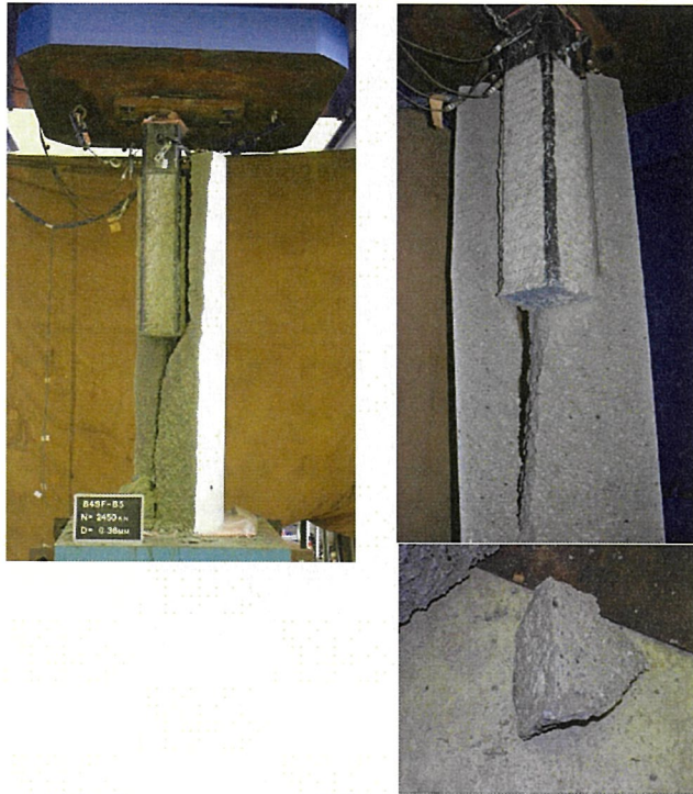
写真 3-1-1 最終破壊状況(B4SF-B5)
