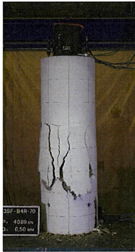
写真 3-4-4 最終破壊状況(B3SF-B4R-70)
