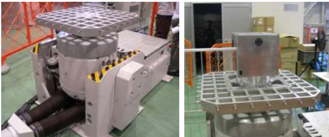
(a) 振動試験機本体 (b) 振動台上のプロイテレス試作機
