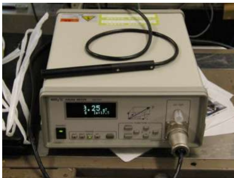
Fig.3-16 ガウスマータ GM5307 の写真
