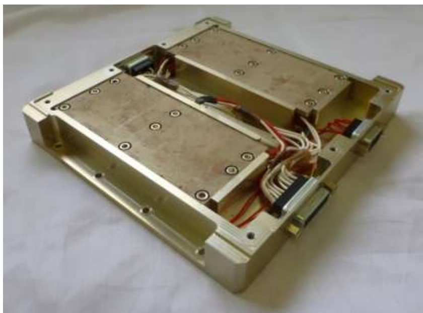
図 3-12 製作したバッテリーユニット
