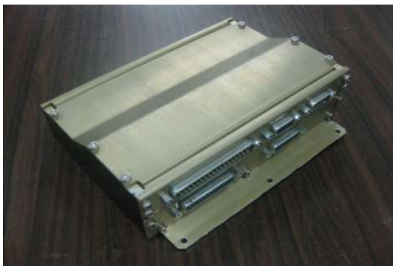
図 3-10 製作した電力供給装置
