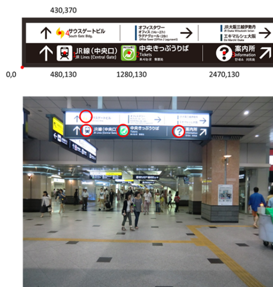
図3. 2. 49 単写真標定測量を用いた自己位置推定（2）
